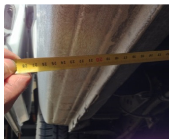
(9) voor controle van de vrije ruimte aan de onderzijde gebruik je vaste referentiepunten zoals bij dorpel of deurstijlen ed.
