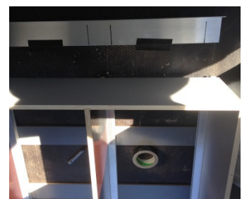
(9) Meet zorgvuldig de plaats uit op de montagebeugel, waar de M8 bouten geplaatst kunnen worden.
